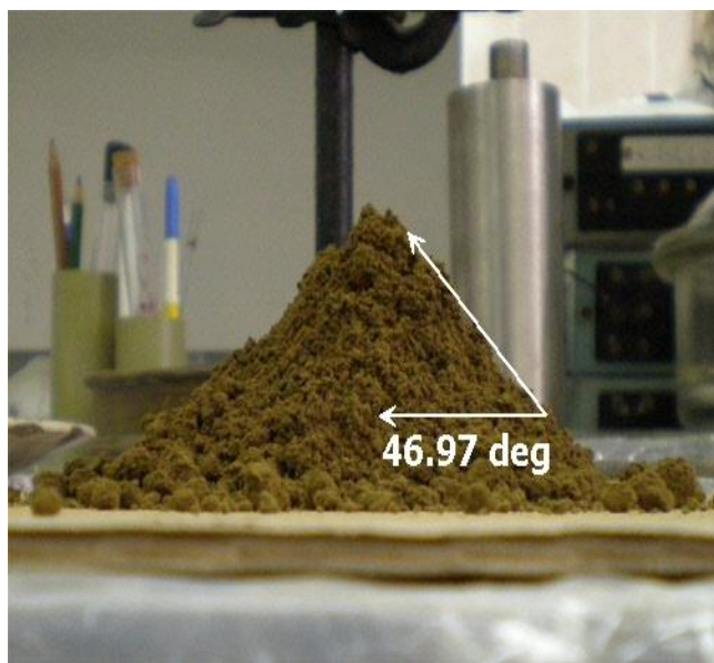
Рис. 12.Угол естественного откоса при влажности 10%. Рис.13.Угол естественного откоса при влажности 15%.
