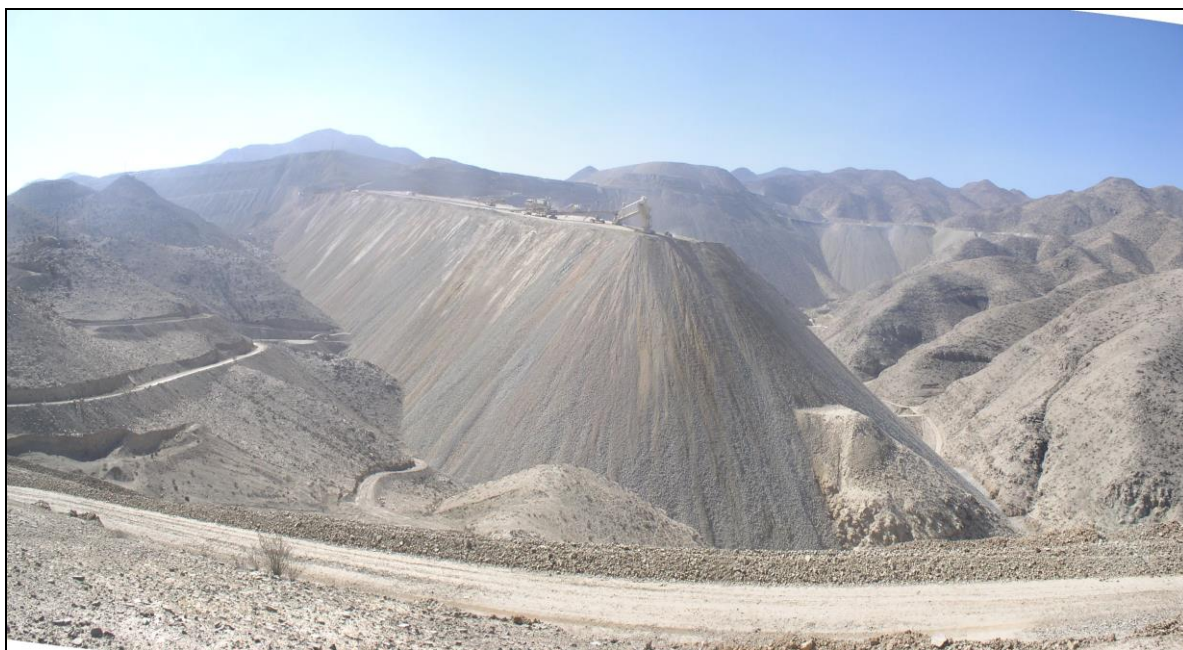
Рис.53. Пионерный способ отвалообразования.
