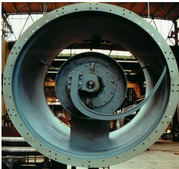
Фото. 39, 40. Рабочий элемент системы механического побуждения выхода золы.
