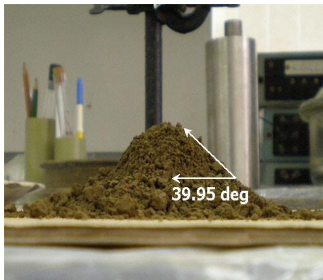
Рис.14 Угол естественного откоса при влажности 20%.
