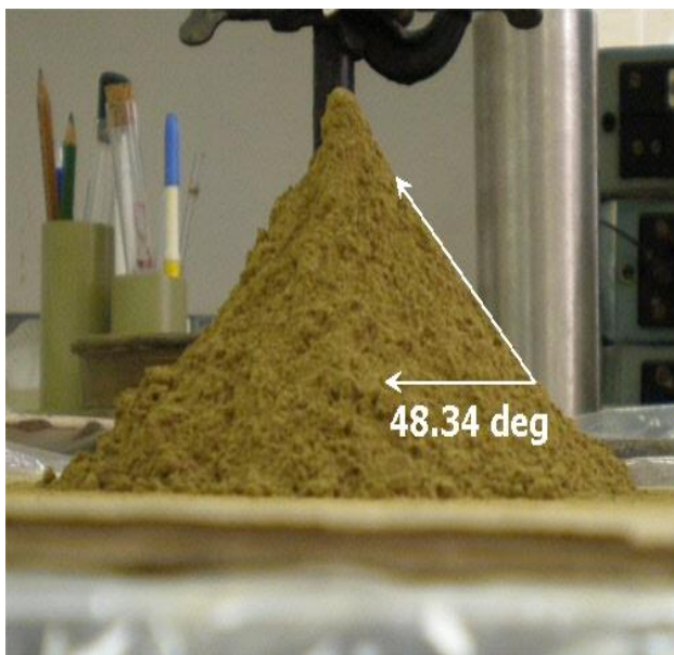
Рис.10.Угол естественного откоса при влажности 0%. Рис.11 Угол естественного откоса при влажности 5%.
