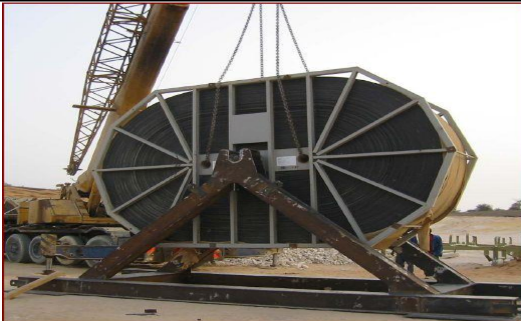
Рис. 48. Лента трубчатого конвейера на транспортном барабане.
