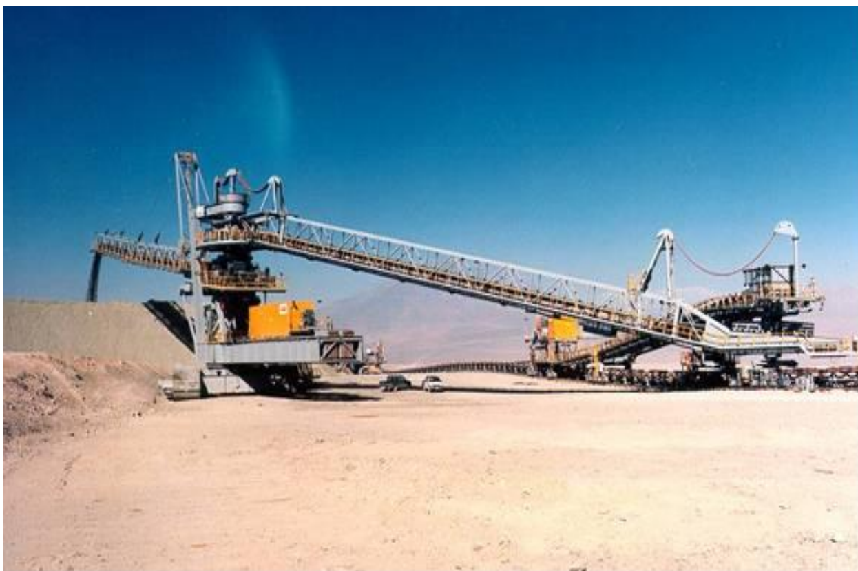
Рис. 56. Отвалообразователь, с верхней противовесной консолью, связанной с платформой. Основные технические показатели отвалообразователя представлены в таблице 7.2.
