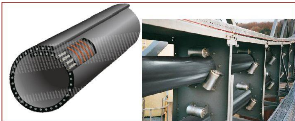
Рис. 47. Конструкция конвейерной ленты и общий вид ТПК.
