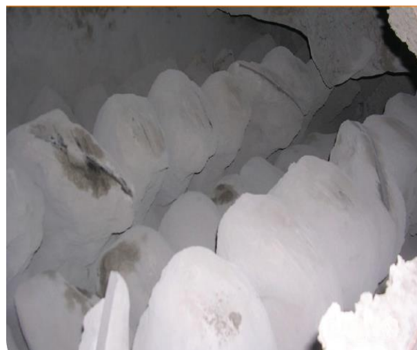
Рис. 30,31. Процесс налипания золы с со содержанием СаО до 15%, на рабочих поверхностях элементов горизонтального смесителя.
