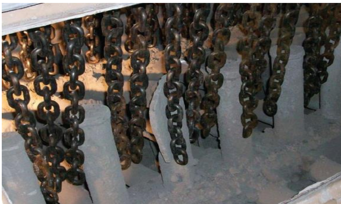
Рис.33. Пример решения системы очистки горизонтальных смесителей.
