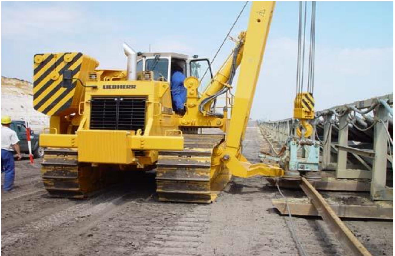
Рис.60. Турнодозер с захватным устройством. Передвижка отвального конвейера.
