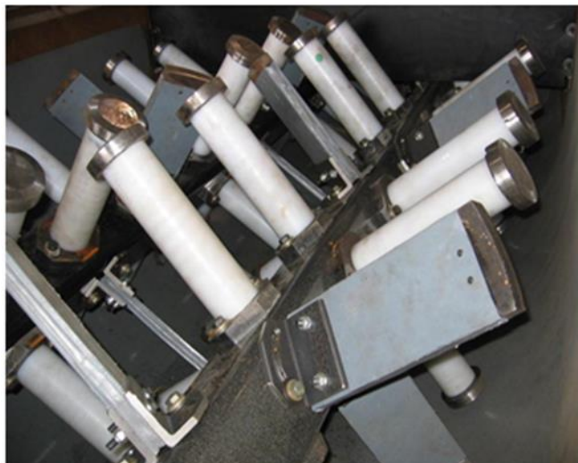
Рис. 32. Пример износостойкого исполнение лопастей горизонтального смесителя.
