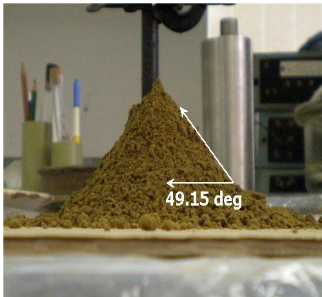
Рис.10.Угол естественного откоса при влажности 0%. Рис.11 Угол естественного откоса при влажности 5%.
