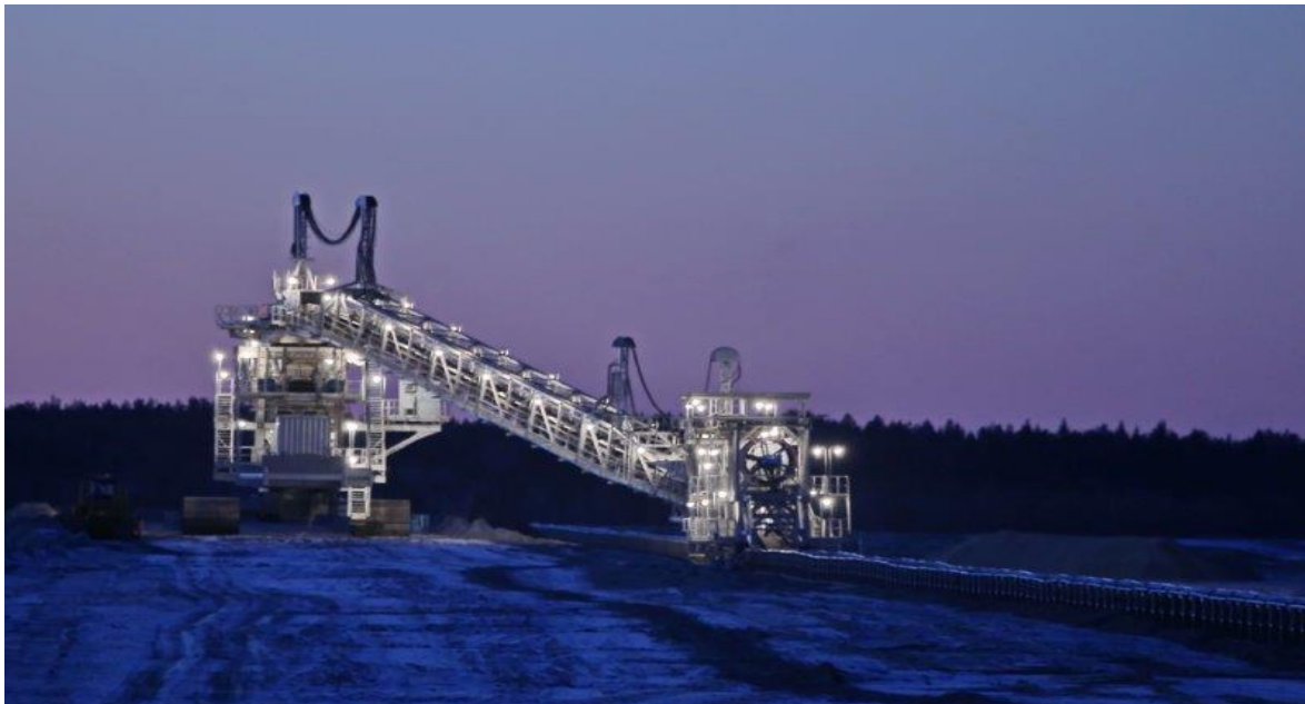
Рис.53.1.Отвалообразователь.Вид со стороны отвального конвейера и подающей стрелы.
