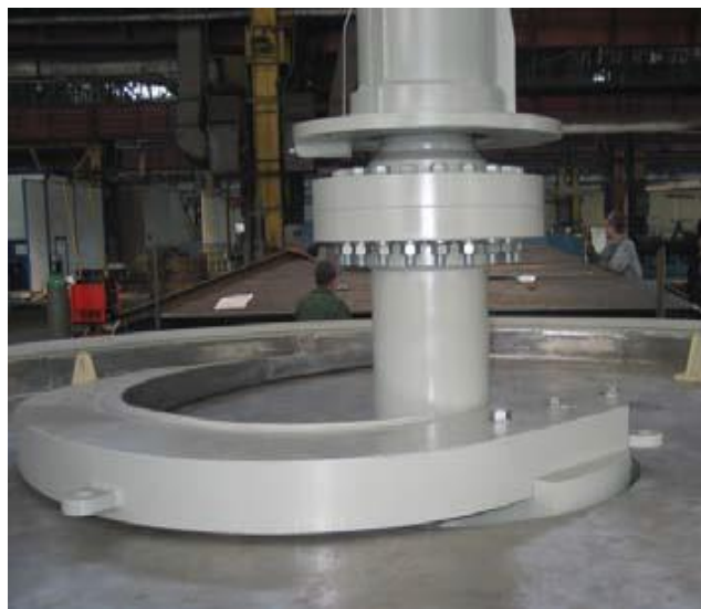
Фото. 39, 40. Рабочий элемент системы механического побуждения выхода золы.
